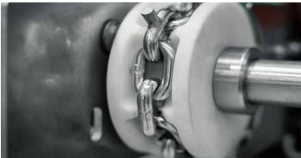
Elektropolierte Oberflächen weisen Flugrost und Schmutz weitgehend ab und sorgen für leichtgängigen Kettenlauf über die Umlenkrollen.
