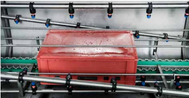
Hochlegierte Förderketten aus rostfreiem Edelstahl: Bestens bewährt bei Hitze und Feuchtigkeit und selbst bei Einsatz aggressiver Reinigungsmittel korrosionsresistent.
