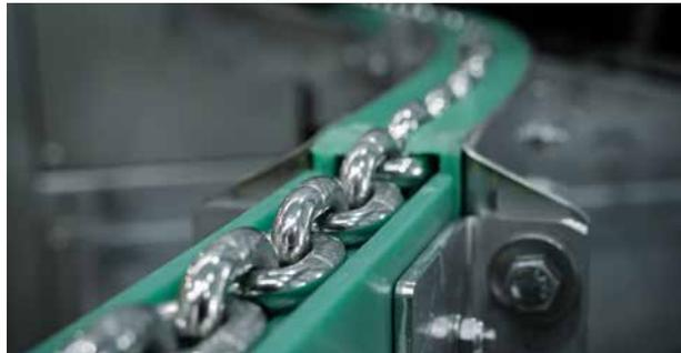
cromox®-Ketten werden aus äußerst widerstandsfähigem und belastbarem 1.4404-Edelstahl oder 1.4462-Duplexstahl gefertigt.
