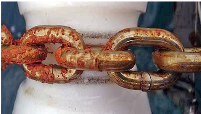
Anodische Korrosion: Diese Kette wurde einer yachtüblichen Spannung von 13,7 Volt ausgesetzt. ©cromox
